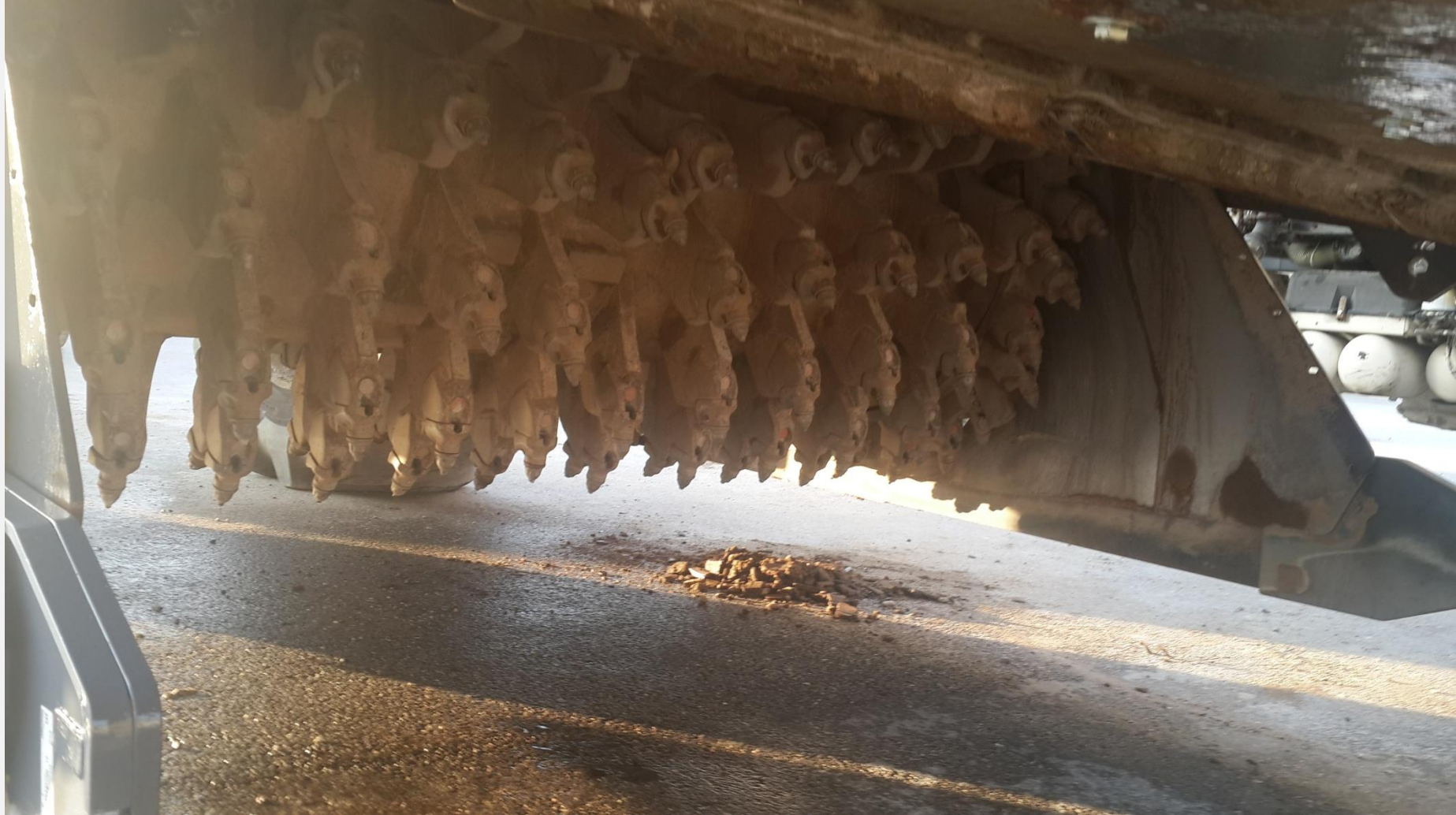
Frezeleme makinesinin elmas uçlu dişleri (28.04.2015)
