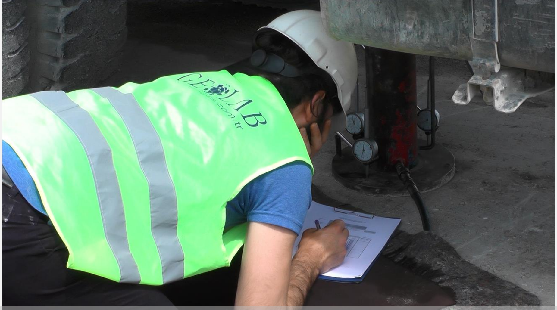
Statik Plaka Yükleme Deneyi (29.04.2015)
