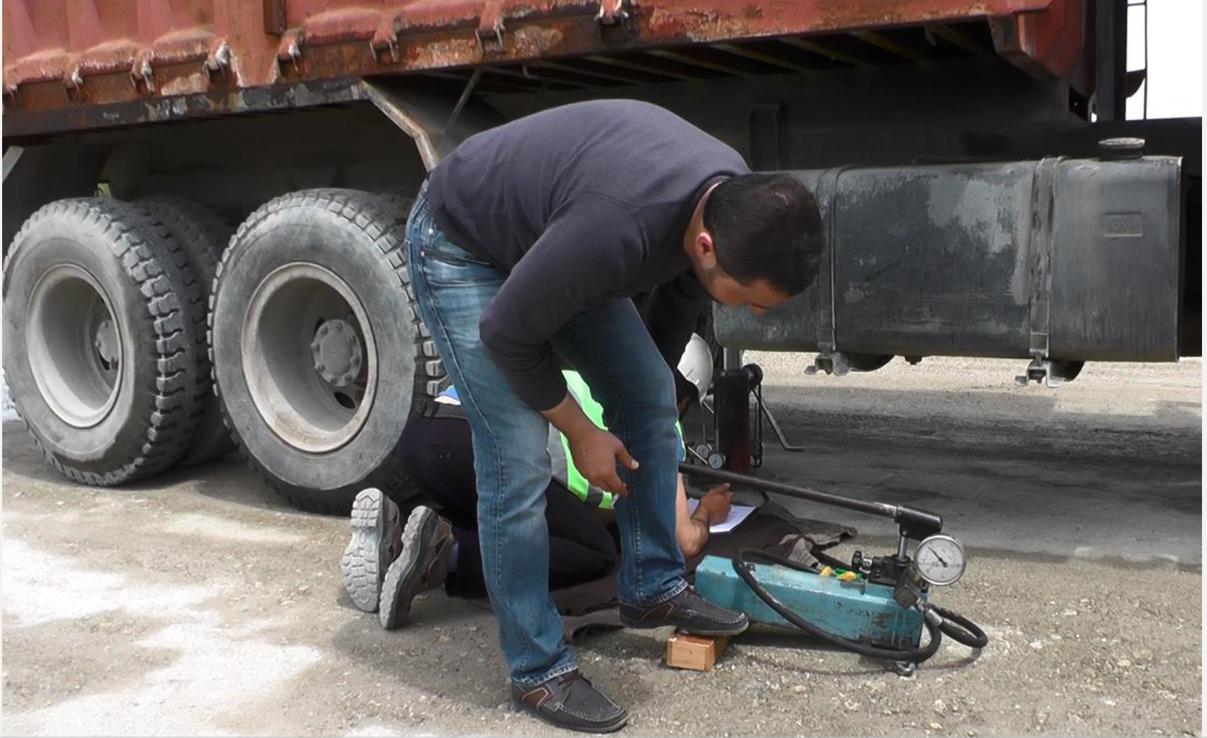
Statik Plaka Yükleme Deneyi (29.04.2015)
