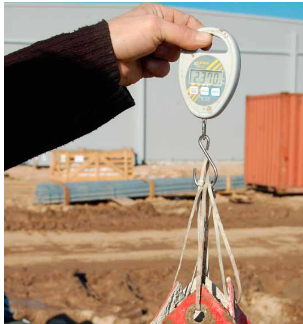
Количество нетто NovoCrete® на данном отрезке составило 1,3 кг/м 2 (контроль рассыпанного количества аддитива при глубине фрезерования 45 см)
