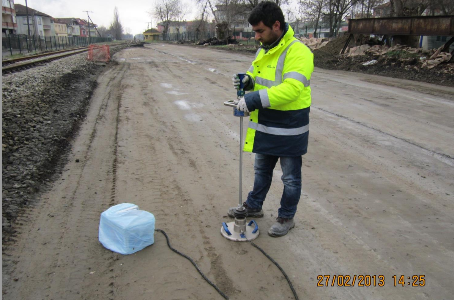
NovoCrete® imalatı sonrası Dinamik Plaka Yükleme Deneyi-27.02.2013
